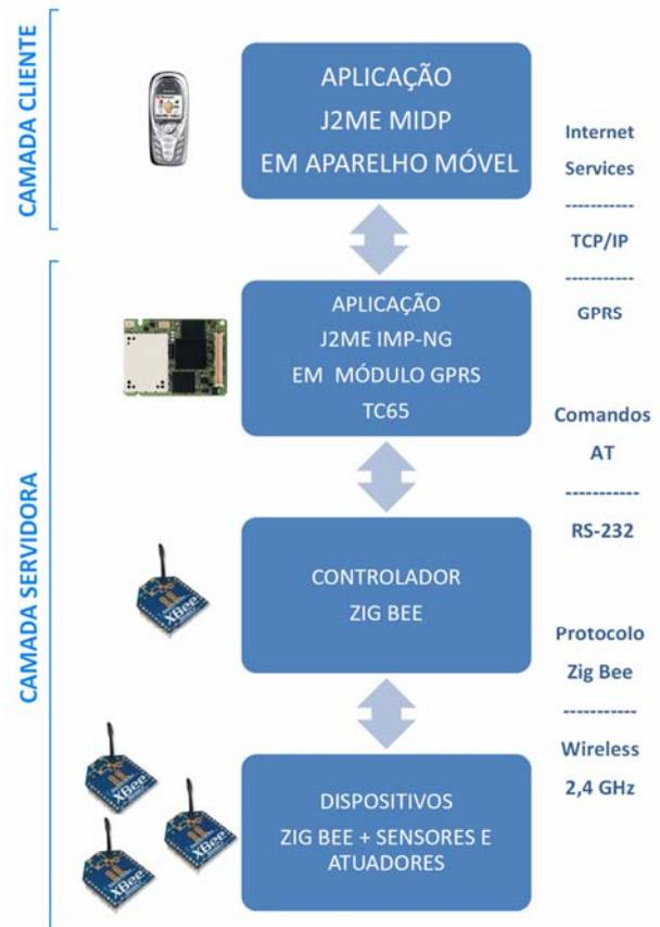
FIGURA 3 – Arquitetura do sistema desenvolvido.
