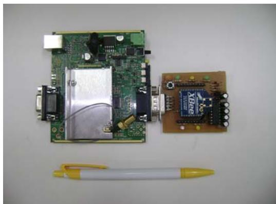
FIGURA 12 – Terminal TC-65 e interface acoplada.
