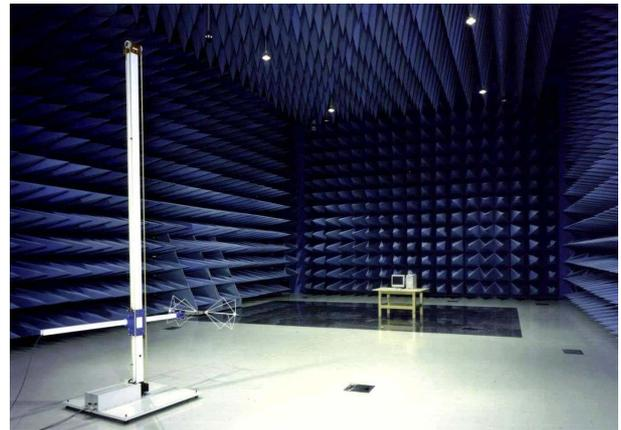
**Figura 4 – Câmara anecóica para medidas de emissões radiadas.**
