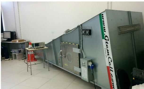
**Figura 11 – Setup testes emissão radiada.**
