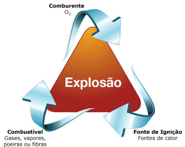
Figura 1 – Triângulo do fogo. Modificado de [ecatalog.weg.net](http://ecatalog.weg.net) (2016)
