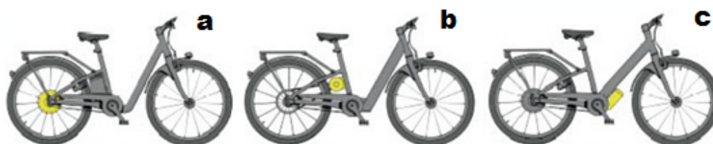
Figura 8 - Configuração da motorização da bicicleta elétrica: - a) Motor no Cubo de roda; b) Motor no Movimento Central; c) Motor na Catraca. Fonte:(SCHÖRNER, 2013).
