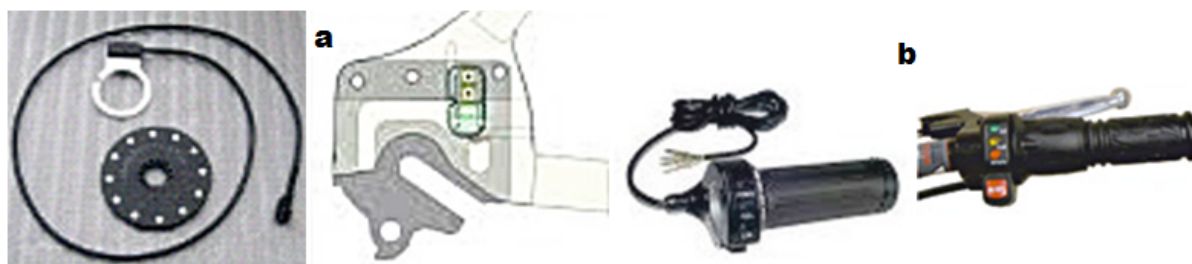
Figura 10: - a) Aceleradores por sensor; b) aceleradores de ação. Fonte: (SCHÖRNER, 2013).
