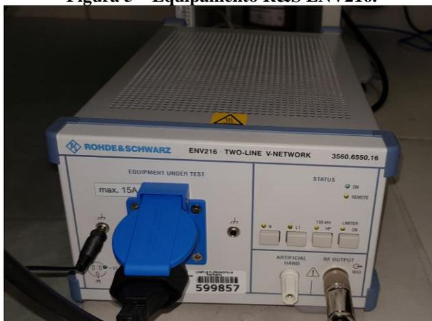
Para realizar as medições, foi conectado a LISN ao analisador de espectro, modelo HMS-X conforme Figura 6.
