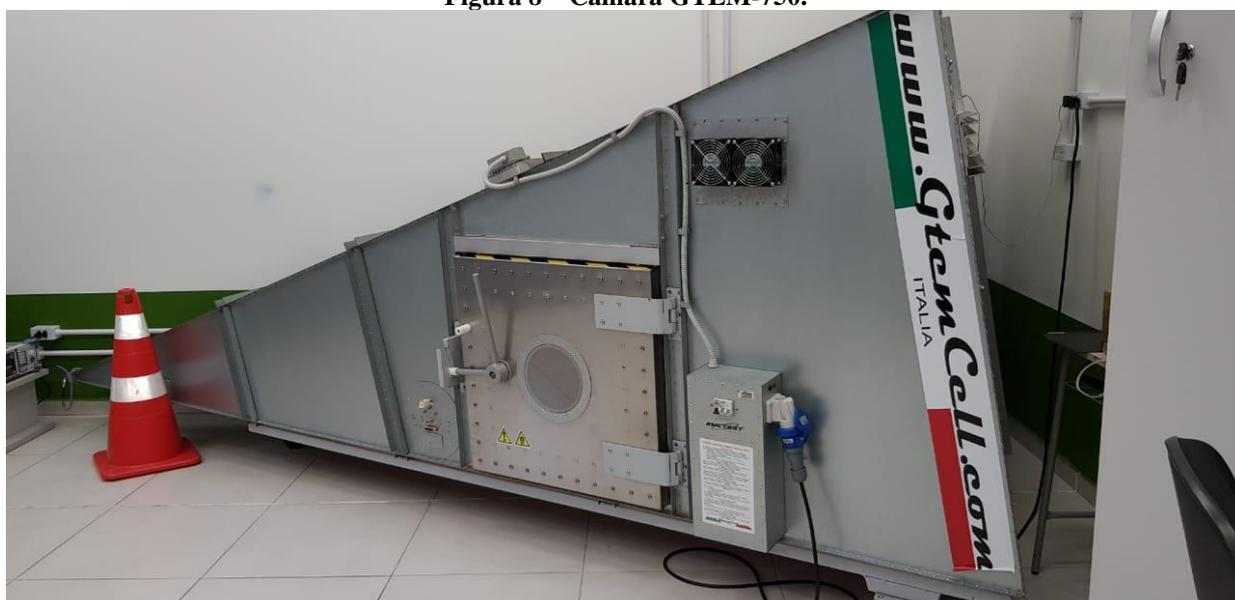
Essa câmara é conectada a um analisador de espectro, marca Rhode & Schwarz, modelo ESL, conforme Figura 9, estes equipamentos, ligados a um computador com software específico instalado, com *setups* das normas pré-configurados.
