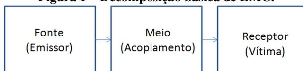
Esta decomposição é dividida em três partes: a primeira é a fonte (emissor) na qual o ruído eletromagnético é gerado; a segunda, o meio por onde esse ruído eletromagnético, se propaga até chegar ao receptor. Este ruído eletromagnético ao chegar ao receptor pode gerar resultados ou efeitos indesejados em sistemas próximos, revelando um problema de compatibilidade eletromagnética.
