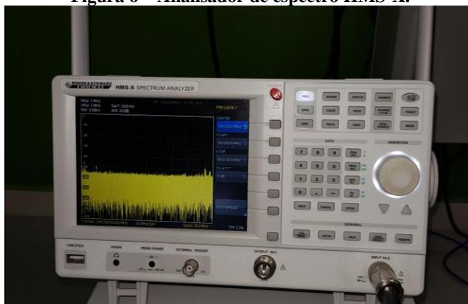
Esses equipamentos, ligados a um computador, com software de análise específico, permitem a realização dos testes de emissão conduzida. A disposição dos equipamentos de medidas e o equipamento em teste, podem ser verificados na Figura 7.
