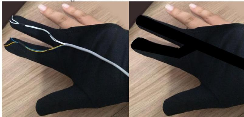
Uma observação final importante para esse teste, para simulação do comportamento dos componentes da luva com a movimentação do pulso foram utilizados fios em vez da placa flexível pois apresentam o mesmo comportamento não elástico nesses movimentos. Há também a necessidade de material excedente para a movimentação do pulso.
