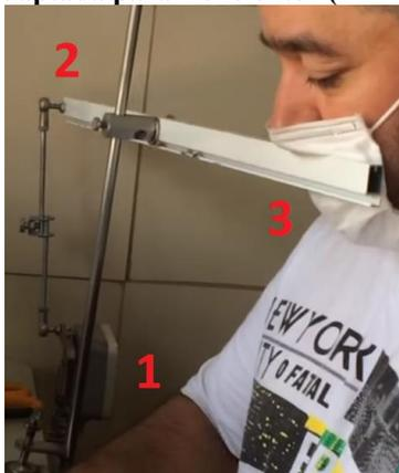
No exemplo da Figura 7, a adaptação ocorre de forma manual, dependendo do uso constante da mão esquerda do costureiro. O controle adaptado do pedal foi feito pelo uso de um cabo de vassoura preso ao pedal da máquina (figura à direita) e chega à mão do usuário através de um furo na mesa (figura superior esquerda), foi colocado, então, um cano de PVC para melhor apoio da mão (figura inferior esquerda).
