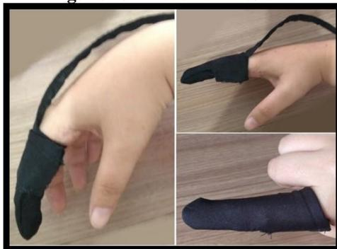
Ao simular o uso com movimentos naturais em uma situação de trabalho, (Figura 16), constatou-se que no caso da dedeira a fixação da placa flexível seria exposta e não segura para o que se busca no projeto, sendo possível a desconexão da mesma por acidental enroscamento. A situação crítica citada é evidenciada na figura superior direita da figura abaixo.
