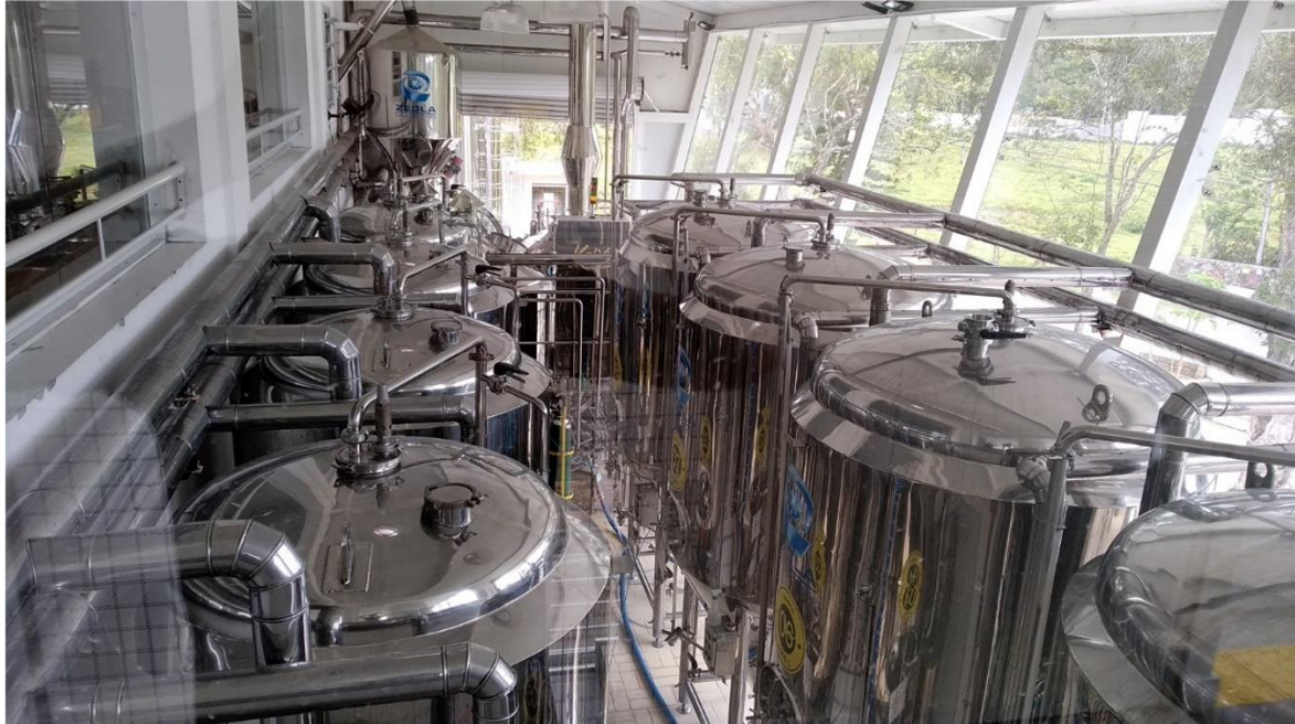
Figura 15 – Fermentadores industriais em aço inox utilizados em etapa de testes de comunicação (CERVEJARIA KAIRÓS, 2019).
