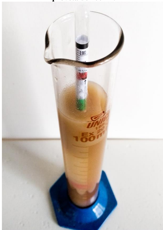
Figura 2 – Representação do uso do densímetro em cerveja. Conteúdo dentro de uma proveta de 100 ml.
