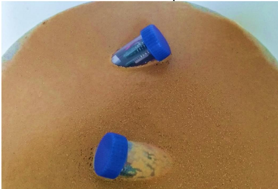
Figura 16 – Terceiro ensaio: dois protótipos inseridos em produção de cerveja artesanal em fermentador plástico.
