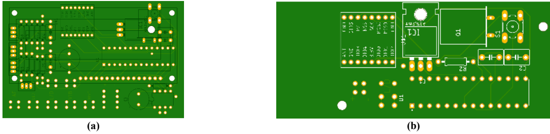
Figura 15 – Layout da placa de circuito impresso: (a) da unidade receptora e (b) da unidade transmissora.
