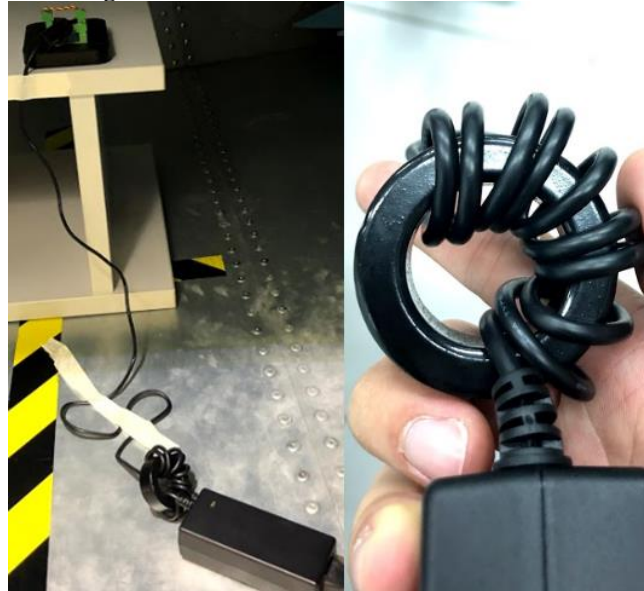
Figura 20 – Fio enrolado em núcleo toroidal.
