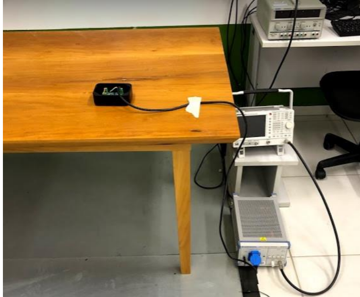
Figura 30 – Ensaio de emissão conduzida sem conversor de energia.
