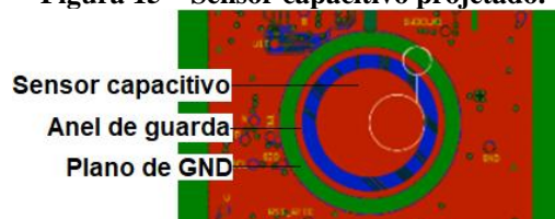
Figura 15 – Sensor capacitivo projetado.
