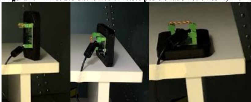
Figura 19 – Produto eletrônico em teste posicionado nos eixos X, Y e Z.
