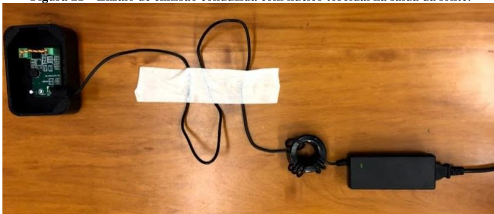
Figura 21 – Ensaio de emissão conduzida com núcleo toroidal na saída da fonte.
