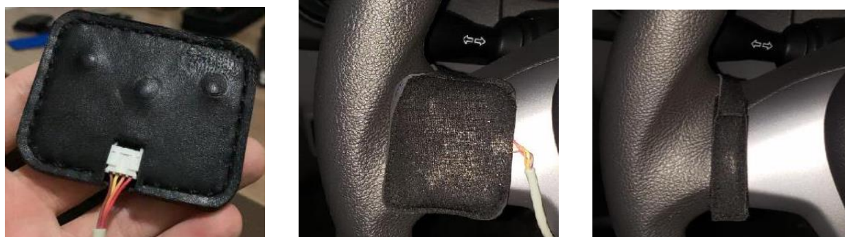
Figura 13 – Invólucro do módulo de acionamento: (a) fabricado em couro, (b) fabricado em Neoprene e (c) fabricado em Neoprene posicionado na posição traseira do volante com abraçadeira.
