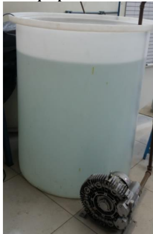
Figura 14 – Tanque para aferir a sonda de nível.
