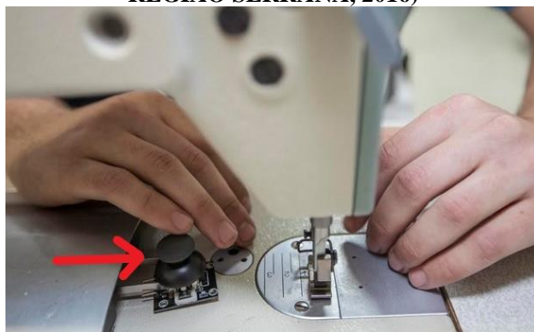
Figura 8 – Adaptação “Acesse Kit de Adaptação para Máquinas de Costura” (G1 REGIÃO SERRANA, 2016)
