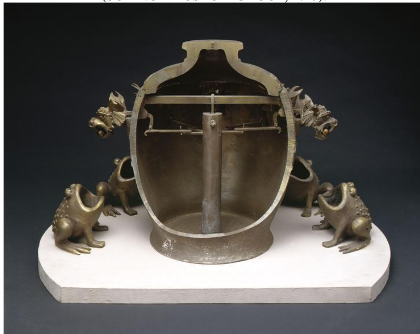
Figura 1 – Modelo do sismômetro de Heng, cortado para mostrar o mecanismo interno. As ondas de choque que chegam deslocam um pêndulo ligado a um mecanismo que abre as mandíbulas do dragão voltado para a direção do terremoto. Uma bola cai dos dentes do dragão na boca de um sapo para registrar o evento. (SCIENCE MUSEUM GROUP, 2023).
