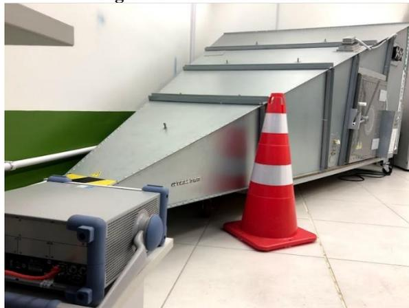
O *setup* de testes foi realizado em três etapas na câmara GTEM, cada uma delas com o equipamento posicionado em eixo diferente (X, Y e Z), conforme demonstrado na Figura 19.
