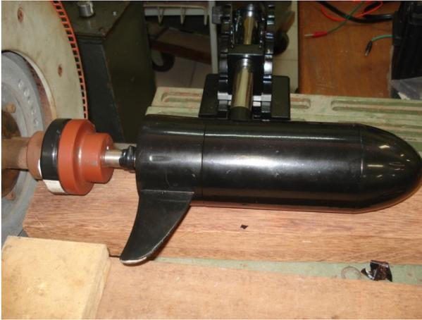
**FIGURA 3 - Detalhe do motor elétrico de corrente contínua blindado.**
