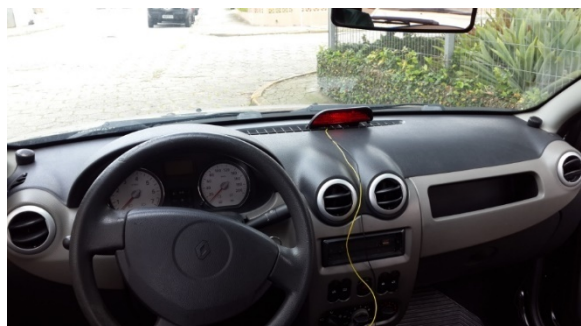
FIGURA 12 - Fixação do brake light no painel central do veículo.
