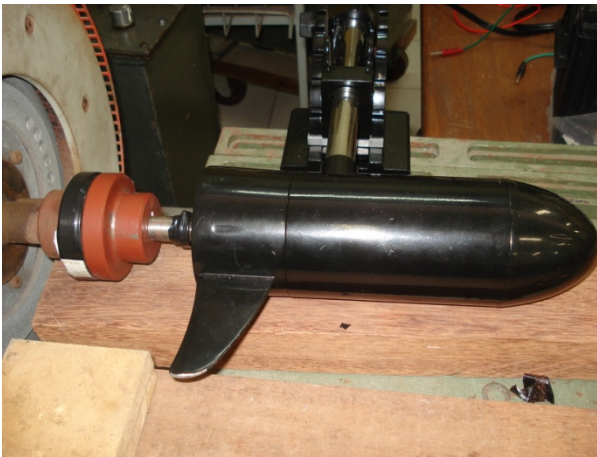
FIGURA 3 - Detalhe do motor elétrico de corrente contínua blindado.
