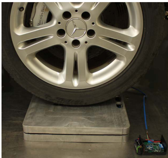
FIGURA 20 – Roda posicionada sobre o pad durante o teste da célula de carga.
