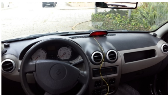
FIGURA 12 - Fixação do brake light no painel central do veículo.
