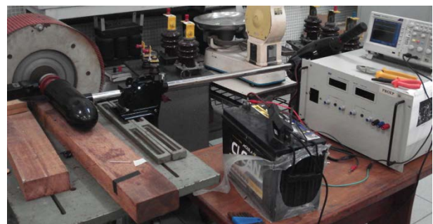
FIGURA 2 - Setup utilizado para teste do rendimento dos motores.
