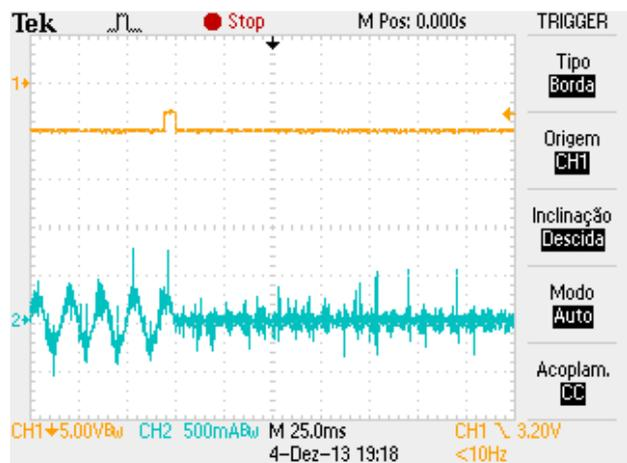
FIGURA 18 – Corrente aplicada na lâmpada ao desligá-la.
