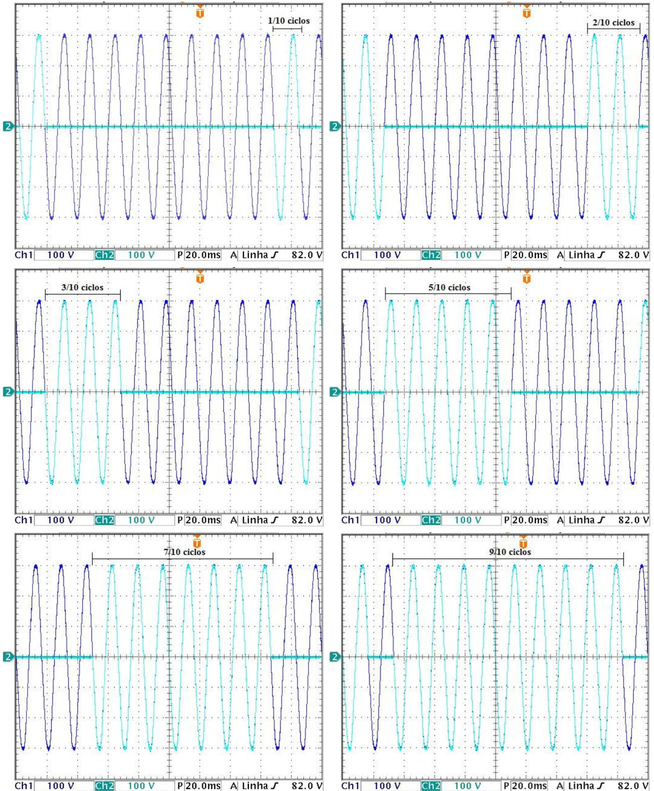
**FIGURA 10 – Aquisições em osciloscópio digital para o comportamento do sinal de saída para carga em relação ao sinal da rede elétrica para  $x/10$  ciclos completos.**
