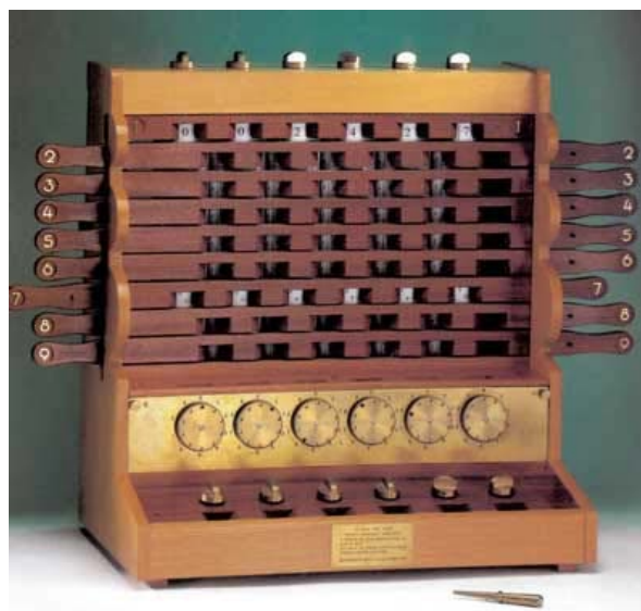
FIGURA 14 – Uma réplica da máquina de Schickard criada por Bruno V. Freytag Löringhoff em 1960 (© Universität Tübingen) (HISTORY OF COMPUTERS, 2014b).
