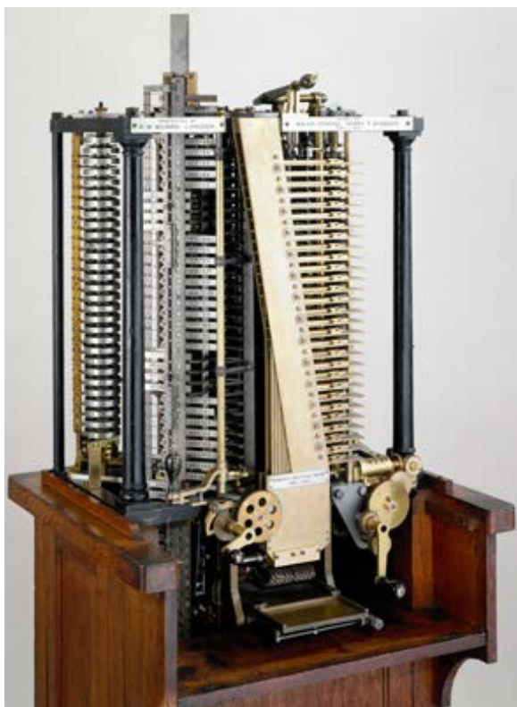
FIGURA 23 – Uma parte do moinho e do mecanismo de impressão construídos por Henry Babbage (Crédito: Science Museum). (COMPUTER HISTORY MUSEUM, 2014e).
