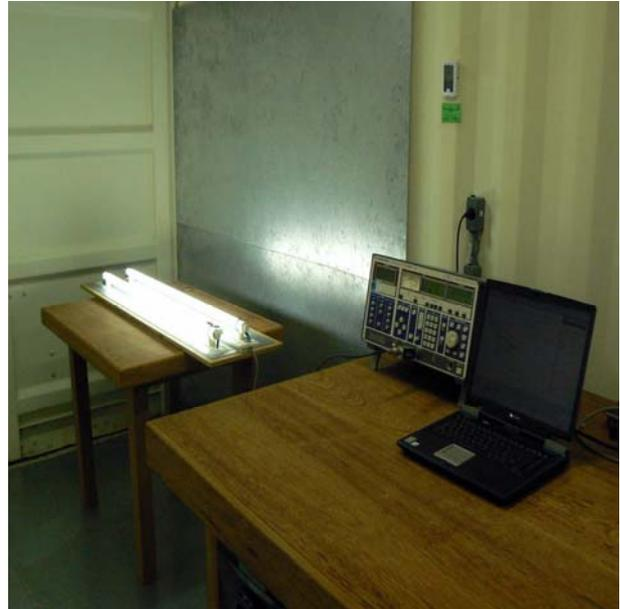
**FIGURA 14 – Configuração de teste de EMI conduzida para reator eletrônico.**
